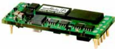
Новая серия преобразователей постоянного напряжения UCE фирмы Murata Power Solutions, Inc. (<http://www.murata-ps.com>) обеспечивает гальваническую развязку (с напряжением до 2250 В) между входом и выходом, мощность до 100 Вт при выходном напряжении 1,2...12 В и токе нагрузки до 40 А. Ма-
