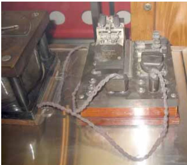
Рис. 25. Тиккер типа ТМ конструкции М.В.Шулейкина (сверху) и изготовитель устройства (снизу). 1915 г.
